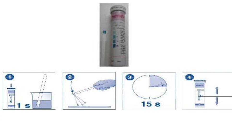
Figure 3 : Méthode d'utilisation des bandelettes de tests peroxyde.
